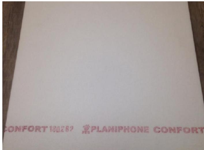
Figure 1a – Exemple de marquage de la sous-couche
