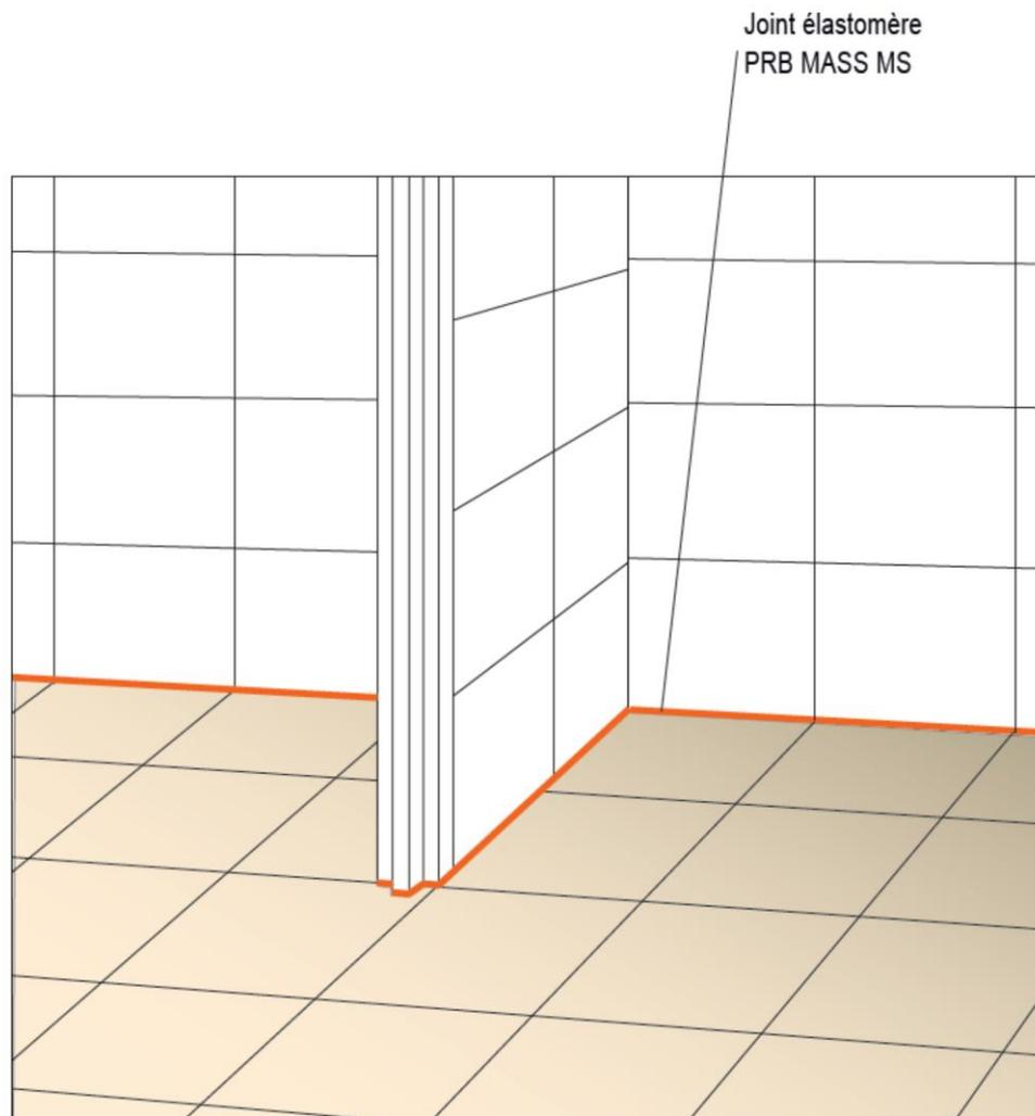
**Figure 10 – Traitement des pieds d'huissier et des angles sol-mur en locaux humides**
