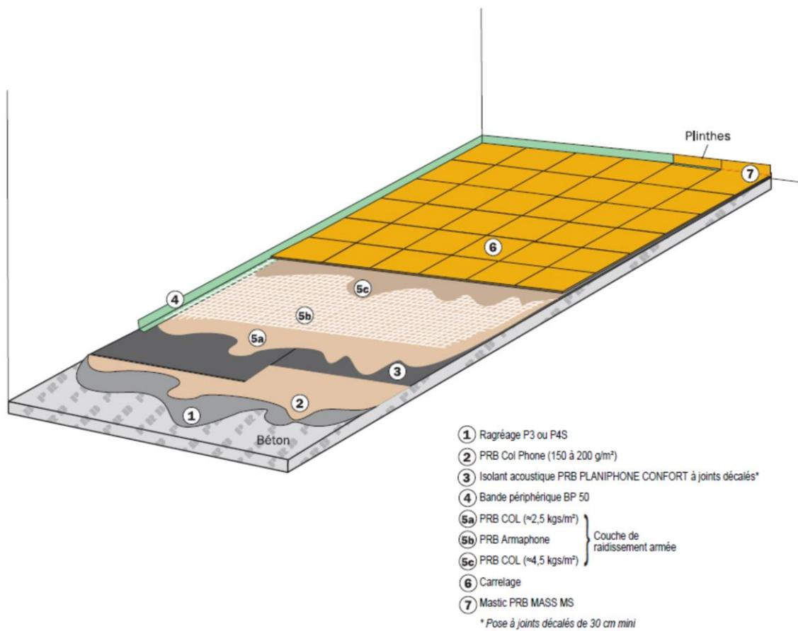
**Figure 1b – Principe de pose du système PRB PLANIPHONE CONFORT avec Armaphone:**
