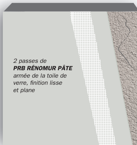
Support irrégulier peint ou revêtu d'un RPE (faïencé et réparé)
